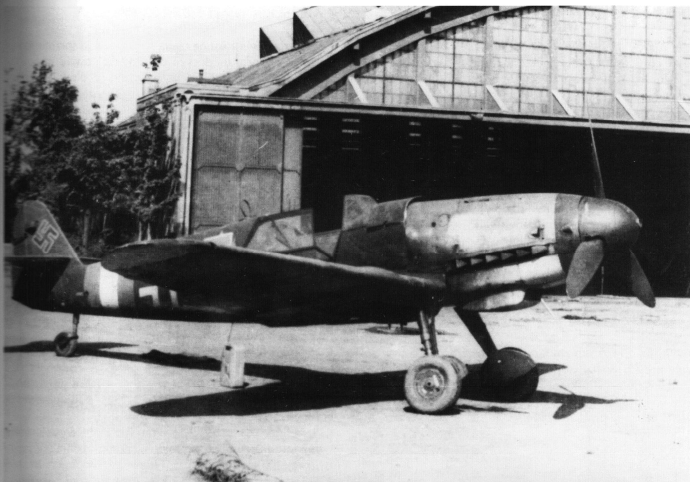
Samoloty Messerschmitt Bf 109 K były rozwinięciem wersji Bf 109 G-10. Na zdjęciu samolot G-10/R3 późnej serii produkcyjnej wyposażony w kabinę typu Erla, opony podwozia głównego o wymiarach 690x190 mm, kółko ogonowe na długiej goleni oraz silnik DB 605 D. Samolot prawdopodobnie pochodzi z JG 51, lotnisko Praha-Kbely, maj 1945 roku. Messerschmitt Bf 109 G-10/R3 probably of the JG 51, Praha-Kbely, May 1945 [Jiri Rajlich]
